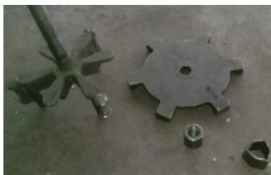
ภาพที่ 4 รูปต้นแบบเครื่องมือถอดประกอบชุดคลัตช์รถจักรยานยนต์ ที่มา: สिरายุส ครุฑโปรง
